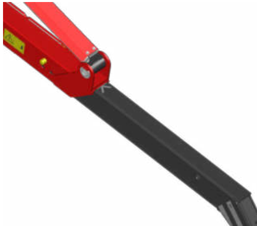
Abbildung 4.6 Ausschiebbaren Teil des Stützfußes entriegeln
